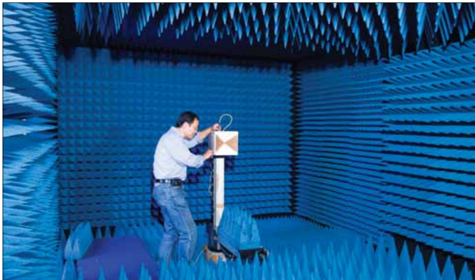
Mikrovågslabb, ekofritt rum för antennmätningar.
